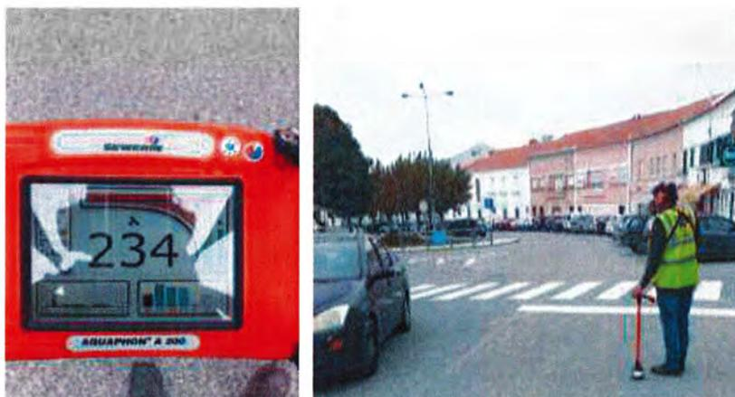
*Figura 12 - Deteção de uma fuga pela equipa especializada*
