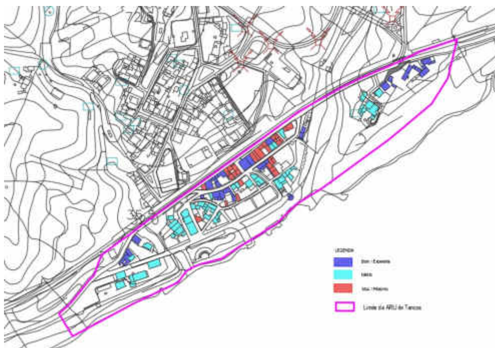
Figura 31. Estado de Conservação do Edificado
